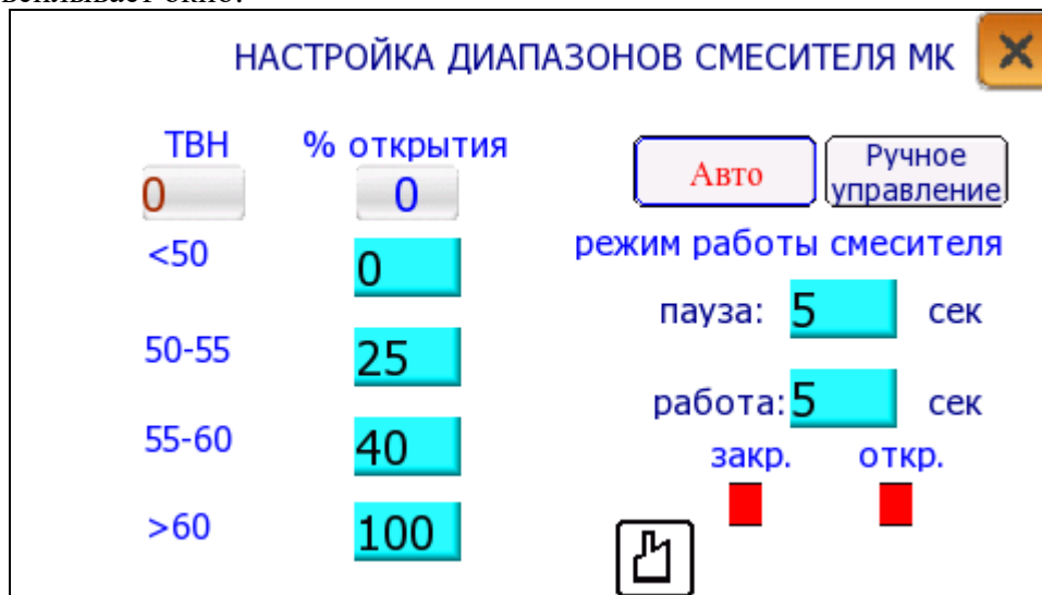
Настройка диапазонов смесителя МК
