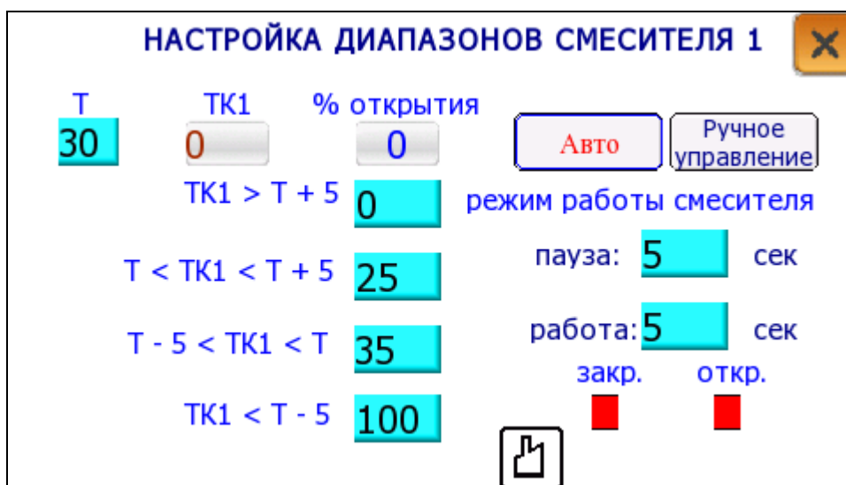
Настройка диапазонов смесителя ТК1
