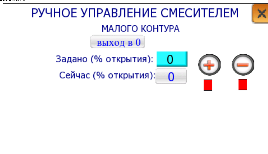
Ручное управление смесителем малого контура
