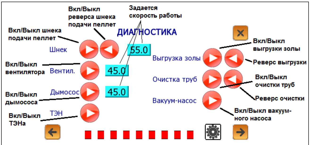
Рис. 25. Включение отдельных агрегатов котла
