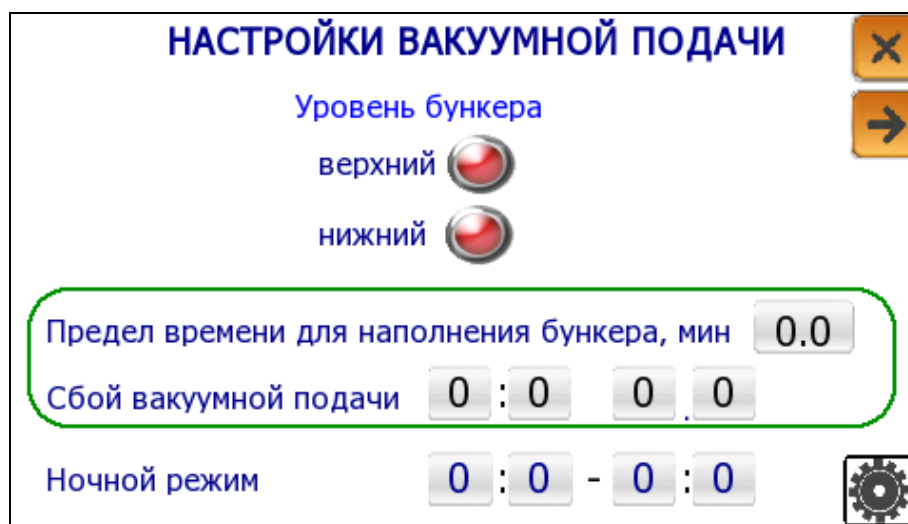
Рис. 11. Настройки вакуумной подачи пеллет.
