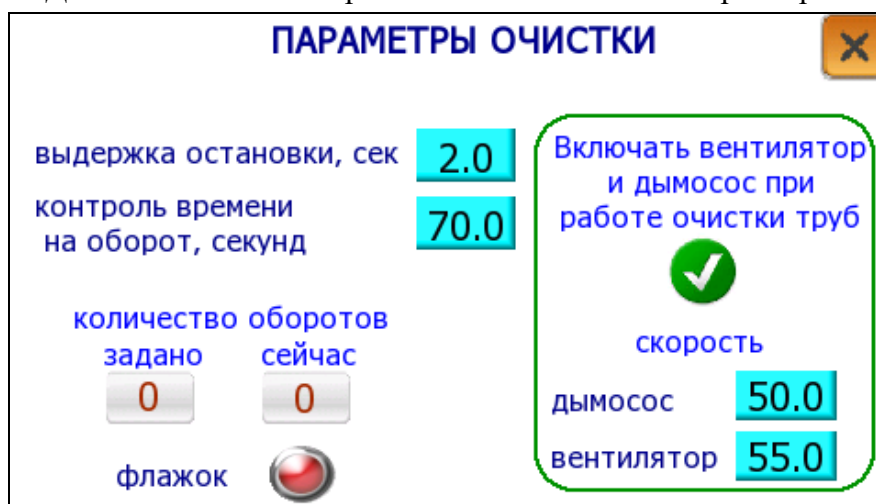
Рис. 14. Настройка очистки в режиме «дополнительные настройки»
