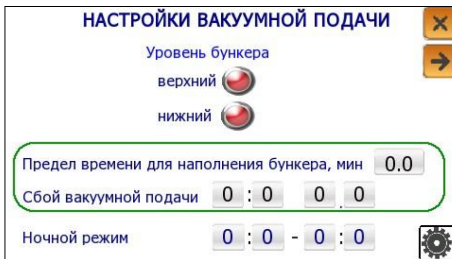
Рис. 11. Настройки вакуумной подачи пеллет.
