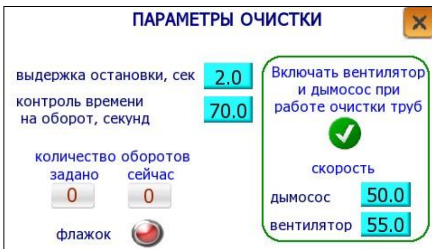
Рис. 14. Настройка очистки в режиме «дополнительные настройки»
