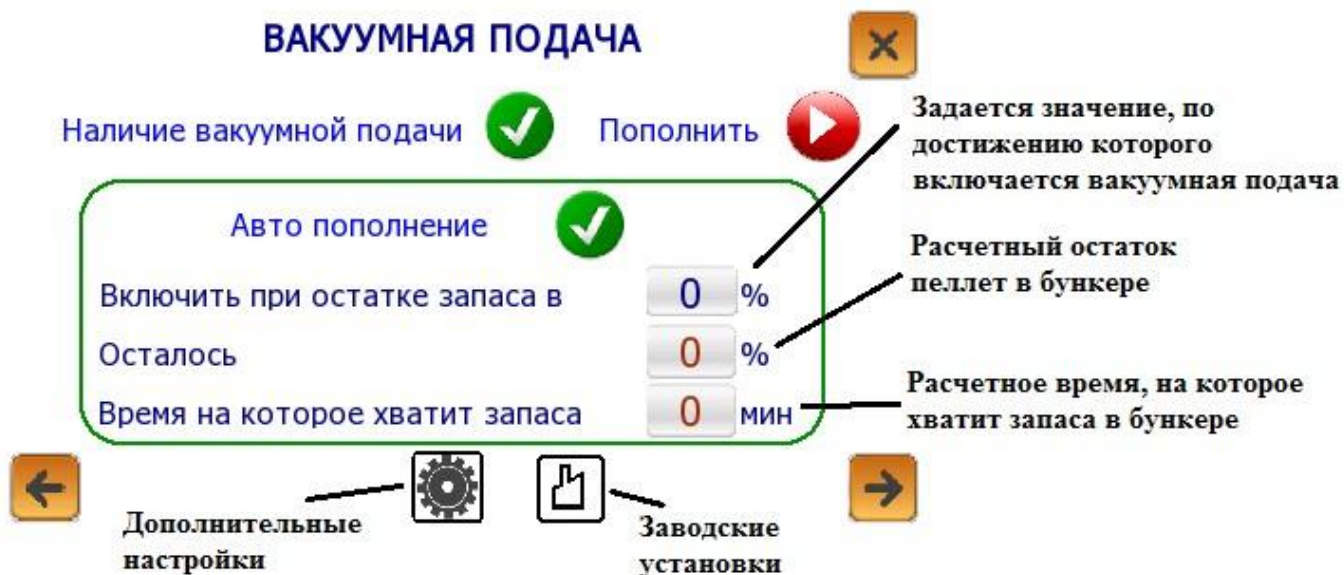
Рис. 10. Настройки вакуумной подачи пеллет.
