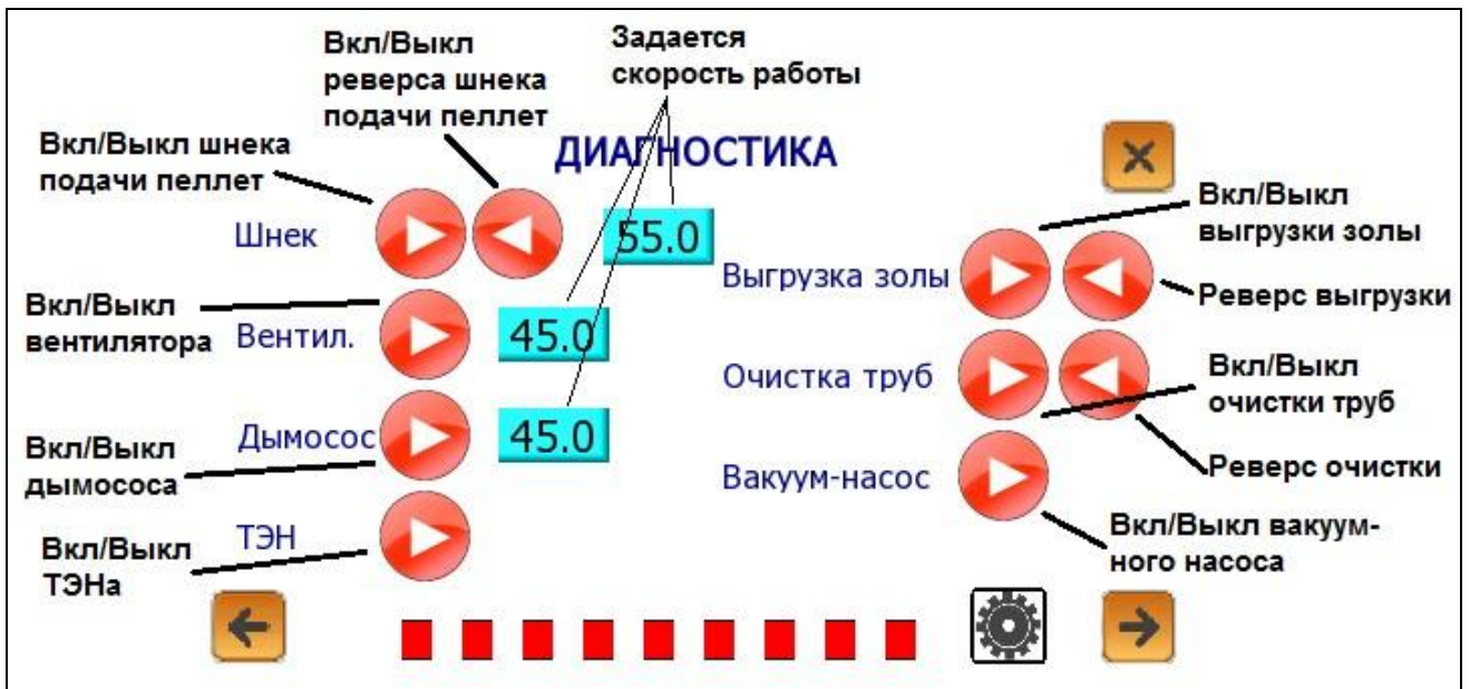
Рис. 25. Включение отдельных агрегатов котла
