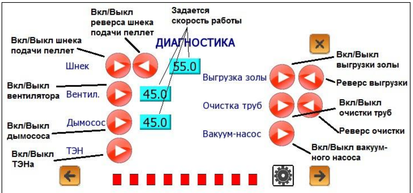
Рис. 25. Включение отдельных агрегатов котла
