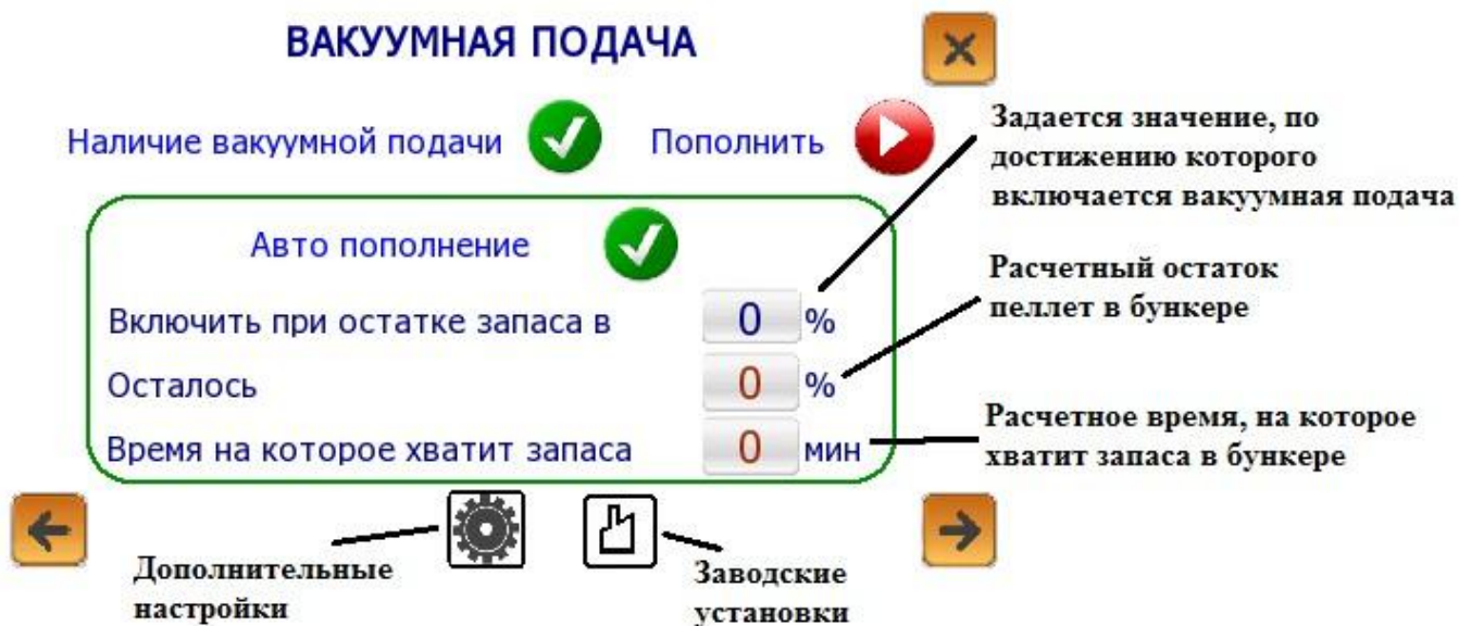
Рис. 10. Настройки вакуумной подачи пеллет.
