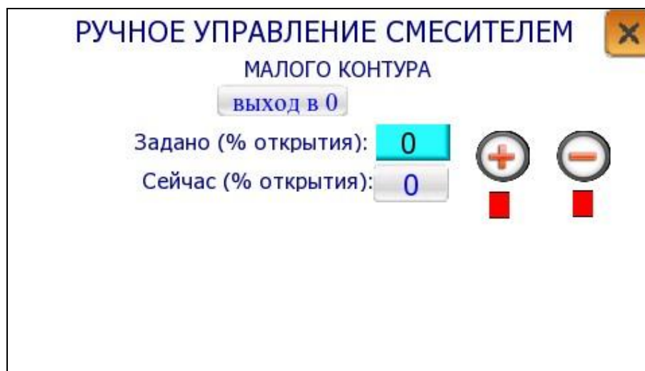
Рис. 19. Ручное управление смесителем малого контура ВНИМАНИЕ!
