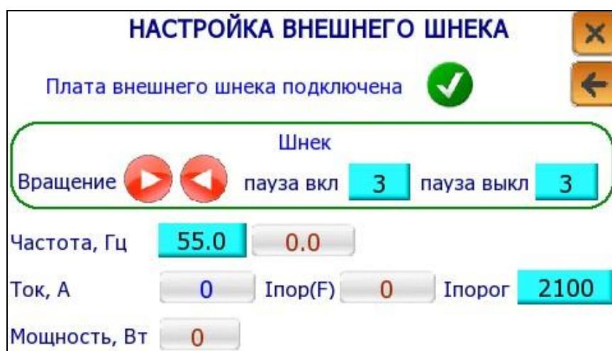
Рис. 12. Настройки шнека подачи пеллет из внешнего хранилища.
